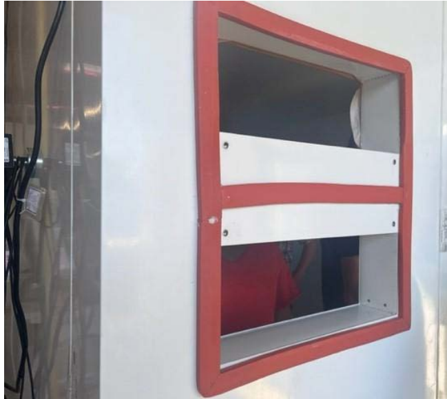
插图24：腔室背面硅胶密封件位于气候箱的位置
