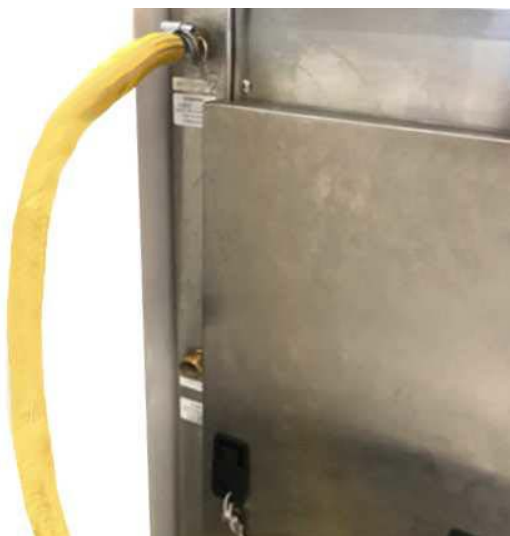
插图 31：将水管连接至淡水入口
