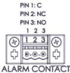
插图 22：用于无电势报警触点的 "ALARM CONTACT"（报警触点）插座 (J) 的引脚分配
