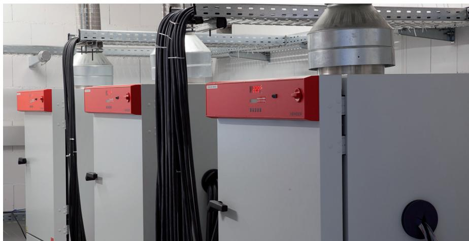
> 用于布线的特殊套管和可加热过压阀
