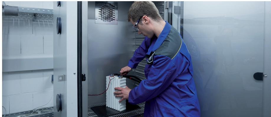
> 模拟变化的环境影响进行电池单元和模块的寿命测试
